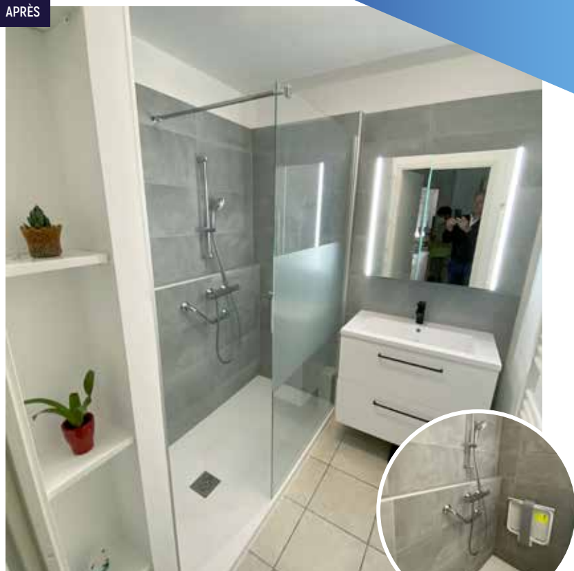
Projet : Remplacement d'une baignoire en douche Nouveau meuble vasque + miroir / Sèche serviette électrique + espace de rangement / Siège de douche pliable + barre d'appui coudée + mitigeur thermostatique
